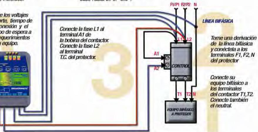
Tome una derivación de la línea bifásica y conéctela a los terminales F1, F2, N del protector
