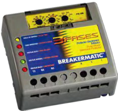
El **BREAKERMATIC 3 Fases Riel Omega (220, 440 y 480V)** supervisa los voltajes de la línea de alimentación para un aparato trifásico, protegiéndolo y evita el arranque de la máquina cuando el sentido de giro dictado por las fases se haya invertido o cuando esté ausente una fase. Posee ajustes para voltaje alto/bajo y ajuste del tiempo de retardo.
