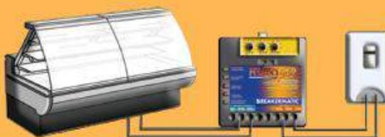
Identifique la "FASE" y el "NEUTRO" en los cables que vienen del breaker con un comprobador de voltaje ( la "FASE" lo enciende, el "NEUTRO" y la "TIERRA" no) y conéctelos en la regleta donde dice "ENTRADA". Identifique los cable que van al equipo a proteger y conéctelos donde dice "SALIDA".
