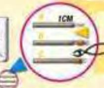
**4** Identifique la FASE y el NEUTRO en los cables que vienen del breaker con un comprobador de voltaje (la FASE lo enciende, el NEUTRO y la TIERRA no) y conéctelos en la regleta donde dice ENTRADA. Asegúrese de montar la tapa protectora de la regleta del BREAKERMATIC Ultra Socket. Finalmente conecte su equipo de refrigeración o Aire Acondicionado a la salida del protector y encienda el Breaker
