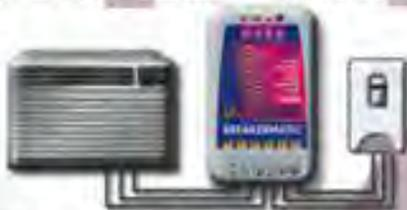
**4** Identifique los cables de "FASE" que vienen del breaker con un comprobador de voltaje (los cables de "FASE" lo encienden, los de "TIERRA" no) y conéctelos en la regleta donde dice "ENTRADA". Identifique los cables que van al equipo a proteger y conéctelos donde dice "SALIDA". Utilice los terminales de "TIERRA", solo si su equipo tiene tres cables en total.
