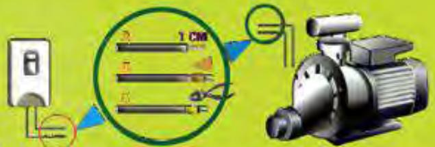
Coloque "firmemente" los terminales suministrados a los cables de la alimentación.
