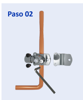
Instalación en la línea de servicio
